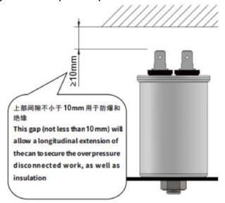
安装及拆卸时应对电容两极进行放电,以免人体与电容两极形成回路触电。 放电时请远离易燃易爆物。短路放电易损伤电容器,且会产生火花及响声。不可大力拉扯电容器电极引出端。禁止碰触运行中或设备停机后未放电的电容器。请勿自行拆解电容。
