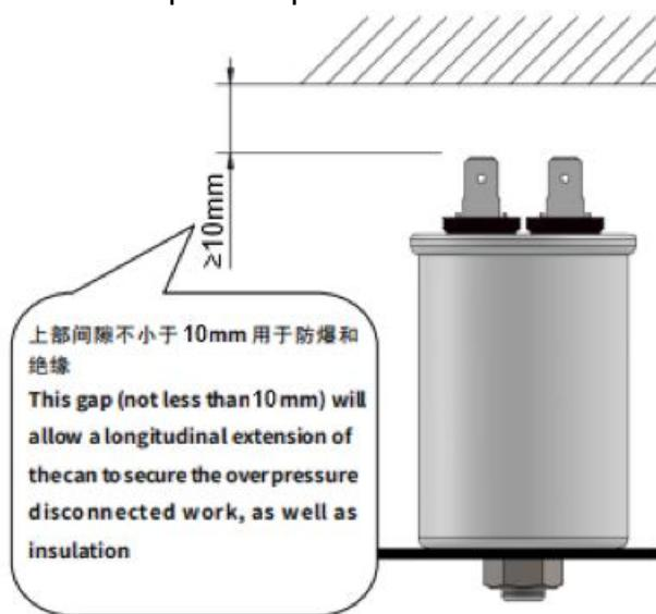
安装及拆卸时应对电容两极进行放电，以免人体与电容两极形成回路触电。放电时请远离易燃易爆物。短路放电易损伤电容器，且会产生火花及响声。不可大力拉扯电容器电极引出端。禁止碰触运行中或设备停机后未放电的电容器。请勿自行拆解电容。
